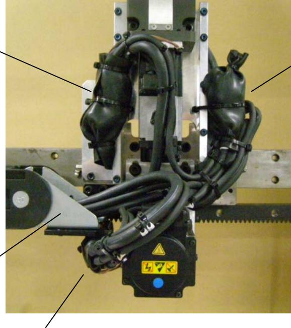
使用绝缘皮等包住S轴的电机电缆和编码器电缆的连接器部，并使用打捆带等将其固定在Z轴托架的侧面。
