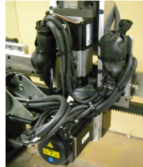
使用绝缘皮等包住L轴的电机电缆和编码器电缆的连接器部，并使用打捆带等将其固定在电缆支架安装支撑上。
