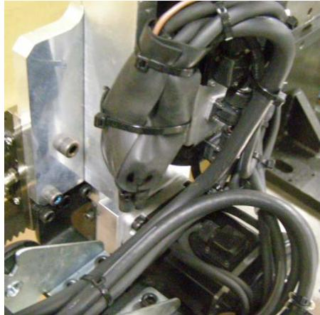
使用打捆带等将本体之间电缆固定在电缆支架安装支撑上。
