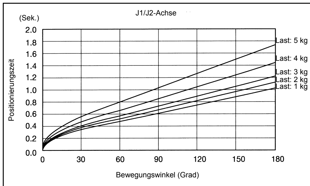
Abbildung 1-26 J1/J2-Achse (Bewegung MOVE P) (VS-D-Serie)
